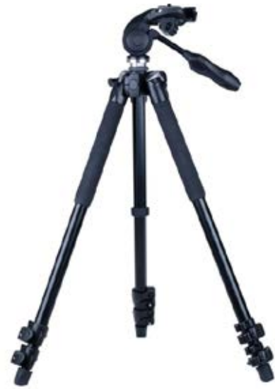
Figura 16: Un treppiede per fotocamera è anche (di solito) accuratamente progettato, ma solo per le fotocamere. Si consiglia di utilizzare treppiedi per il rilievo quando si eseguono misurazioni, con o senza un compensatore biassiale attivo.
