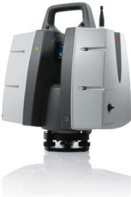
Figura 1: ScanStation Leica P40, laser scanner per il rilievo, con sensore di inclinazione integrato, montato su basamento tricuspide. Il basamento ha tre piccole ruote per permettere il corretto livellamento.
