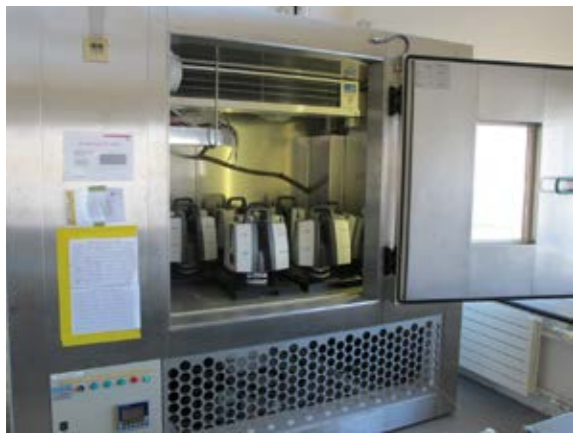
Figura 12: Camera ambientale per cicli termici per i laser scanner serie P e C. Questa stazione è chiamata ESS, o screening di stress ambientale.
