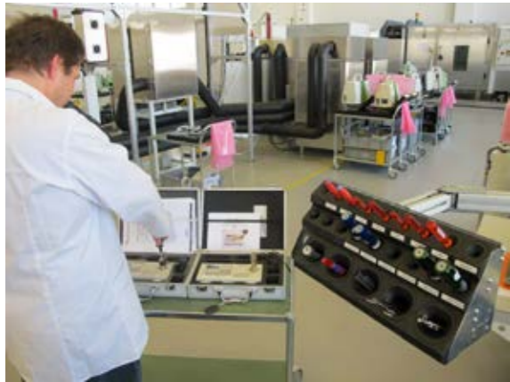
Figura 11: Una serie di chiavi dinamometriche calibrate sulla serie P e C del piano di produzione in una stazione di montaggio, viene confrontato con un riferimento di coppia calibrata.
